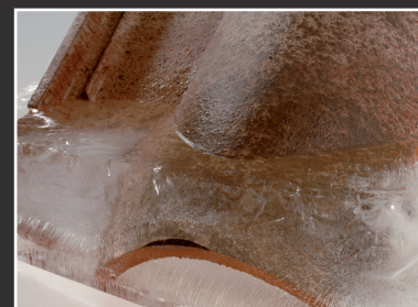
Helicidad NFM - metodo E - 150 ciclos de hielo y dehielo
